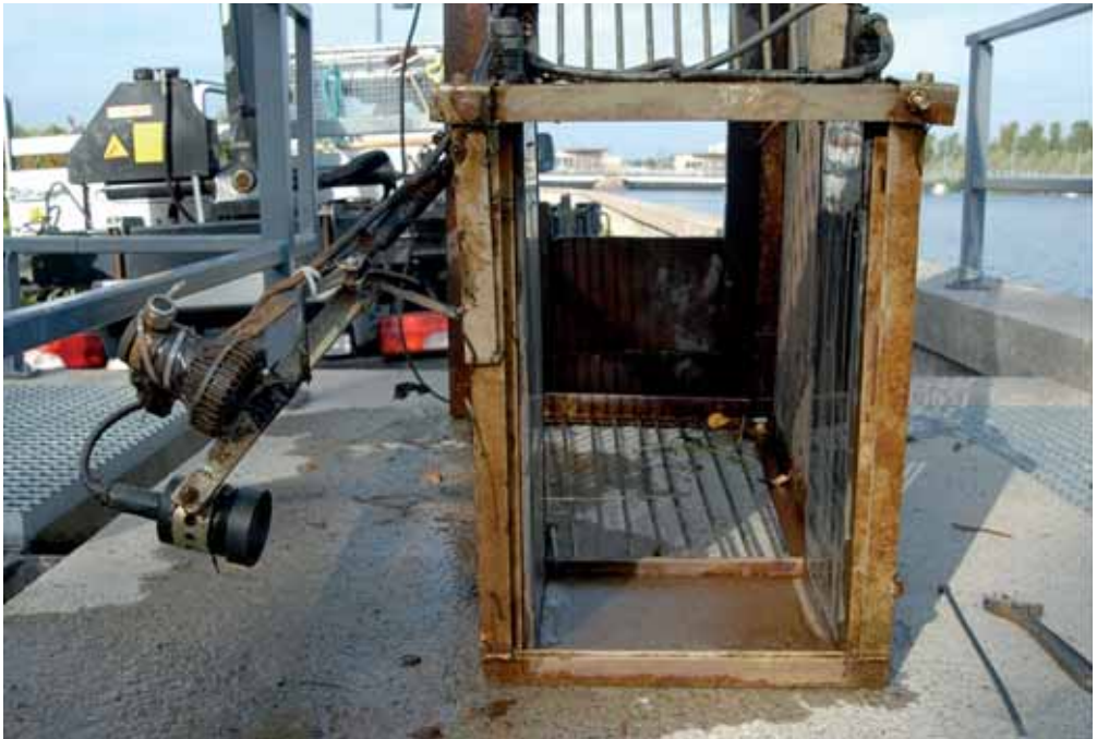
Kuva 5. Oulujoen tutkimuksessa käytössä olleen Vaki-laskurin havainnointiyksikkö ja yksikköön erikseen asennettu videokamera ja halogeenivalaisin. Kuva: P. Orell.
