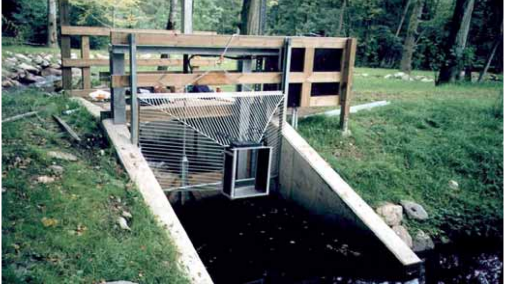
Kuva 1. Vaki-laskurin veden alle asennettava havainnointiyksikkö (scanner unit) ja ohjauskehikko, joka ohjaa kalan uimaan havainnointiyksikön lävitse. Kuvan ohjauskehikko on kiinnitetty kiskoihin, jolloin laite on helppo nostaa vinssin avulla vedestä puhdistuksen ja huollon ajaksi. Kuva: Vaki Aquaculture Systems Ltd
